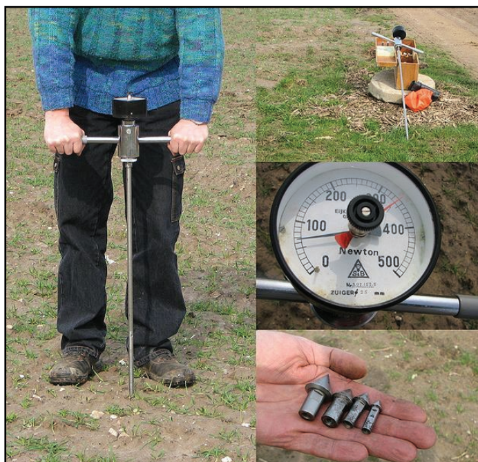
Figura 8: Penetrómetro con su escala (en newtons) y distintos tipos de puntas.
